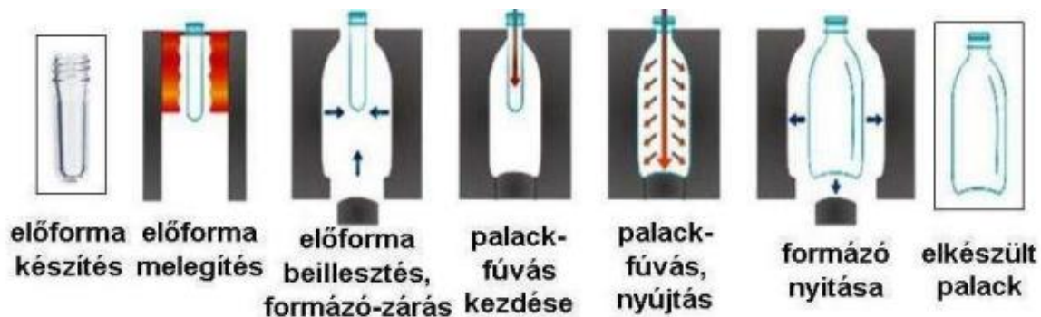
2.ábra: A palackfúvás technológiája
